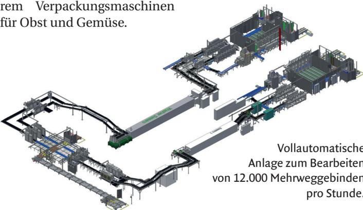
Vollautomatische Anlage zum Bearbeiten von 12.000 Mehrweggebinden pro Stunde.
